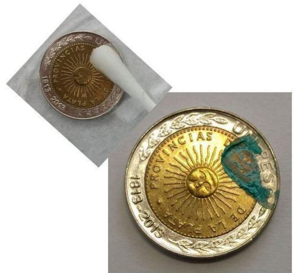
Figura 8 Moneda de $1 luego del ensayo que duró 24 horas, donde como se puede apreciar, hubo corrosión.
