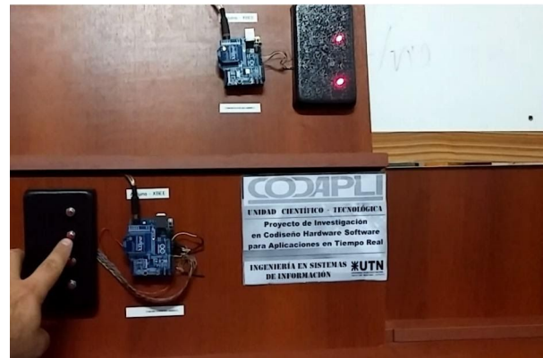
Fig. 2. Prototipo de sistema transmisor-receptor con módulos XBee desarrollado en CODAPLI
