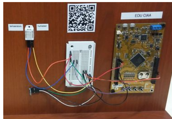
Fig. 4. Prototipo de estación meteorológica utilizando una placa EDU-CIAA para la adquisición de datos.
