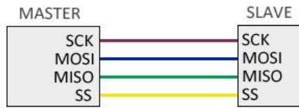
Fig. 10. Líneas necesarias para establecer una conexión SPI full-duplex
